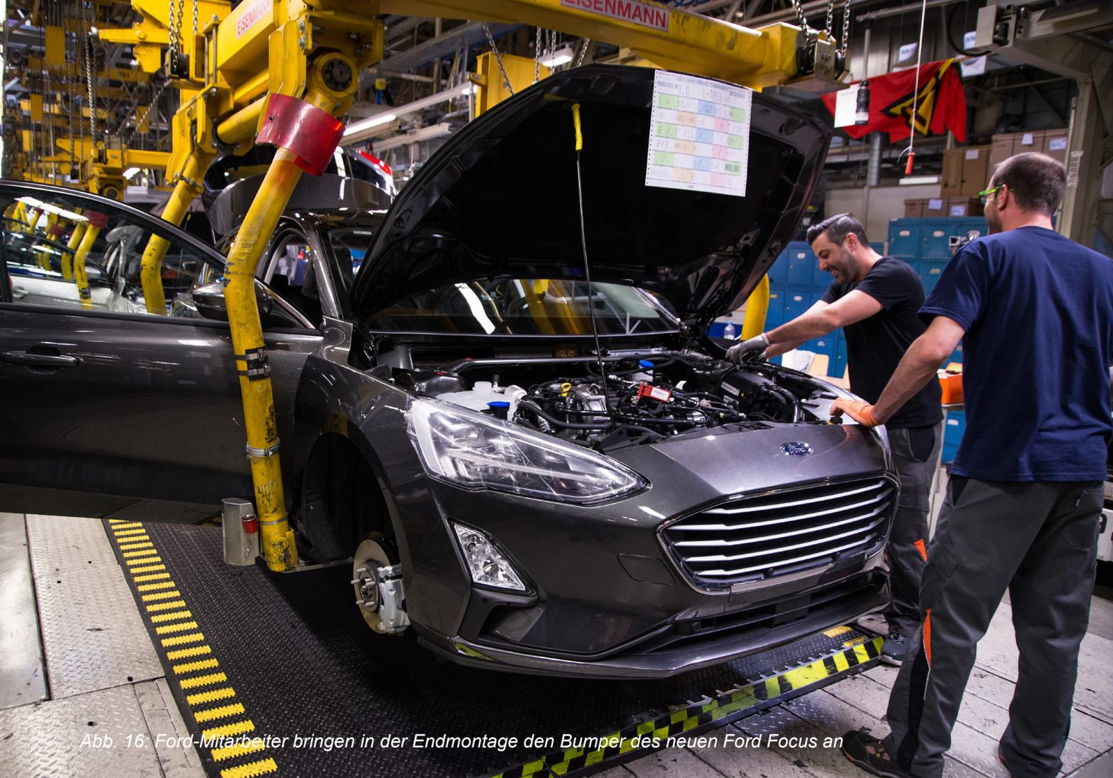
Abb. 16: Ford-Mitarbeiter bringen in der Endmontage den Bumper des neuen Ford Focus an
