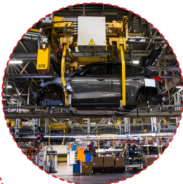
Abb. 17: Ein neuer Ford Focus beim Ablauf von der Final-Line in der Endmontage
