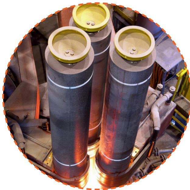
Abb. 9: Sekundärmetallurgie Pfannenöfen bei Saarstahl
